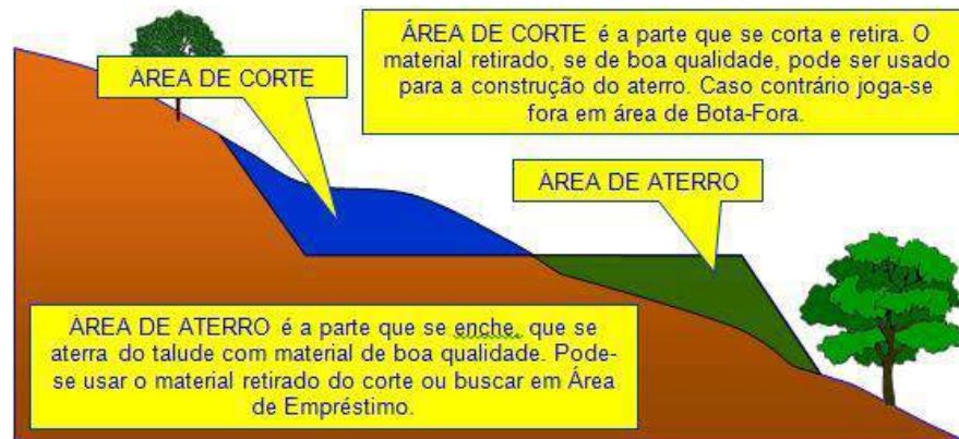
Figura 8 Ilustração e definição corte e aterro 10
