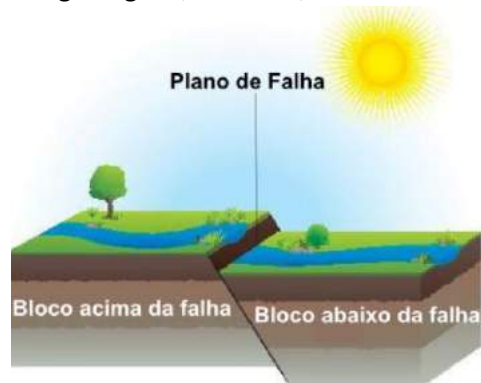
Figura 10 Esquema de uma falha geológica que pode dar origem a um terremoto 15
